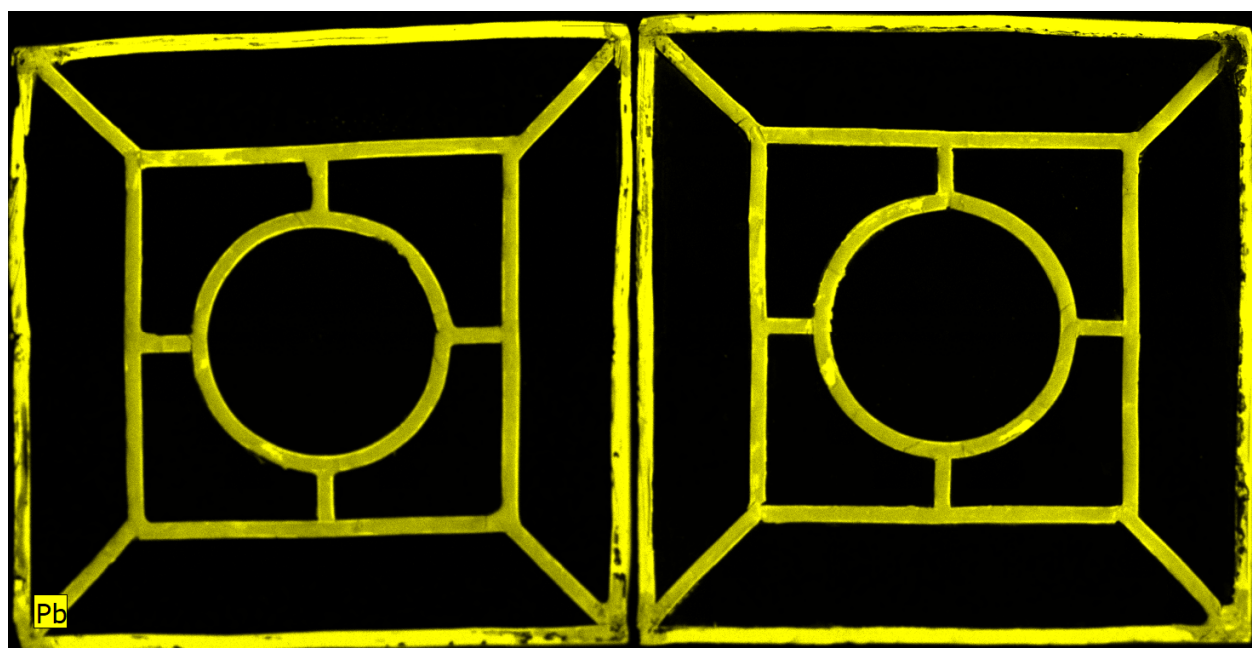
Pb-LB. Mapa rozkładu ołowiu – od strony zewnętrznej
