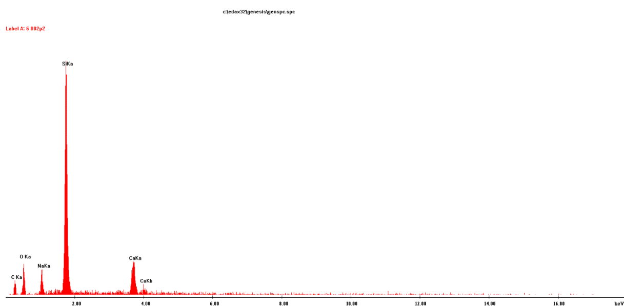
Rys. 131. Widma fluorescencji rentgenowskiej próbki nr 6, punktu 2
