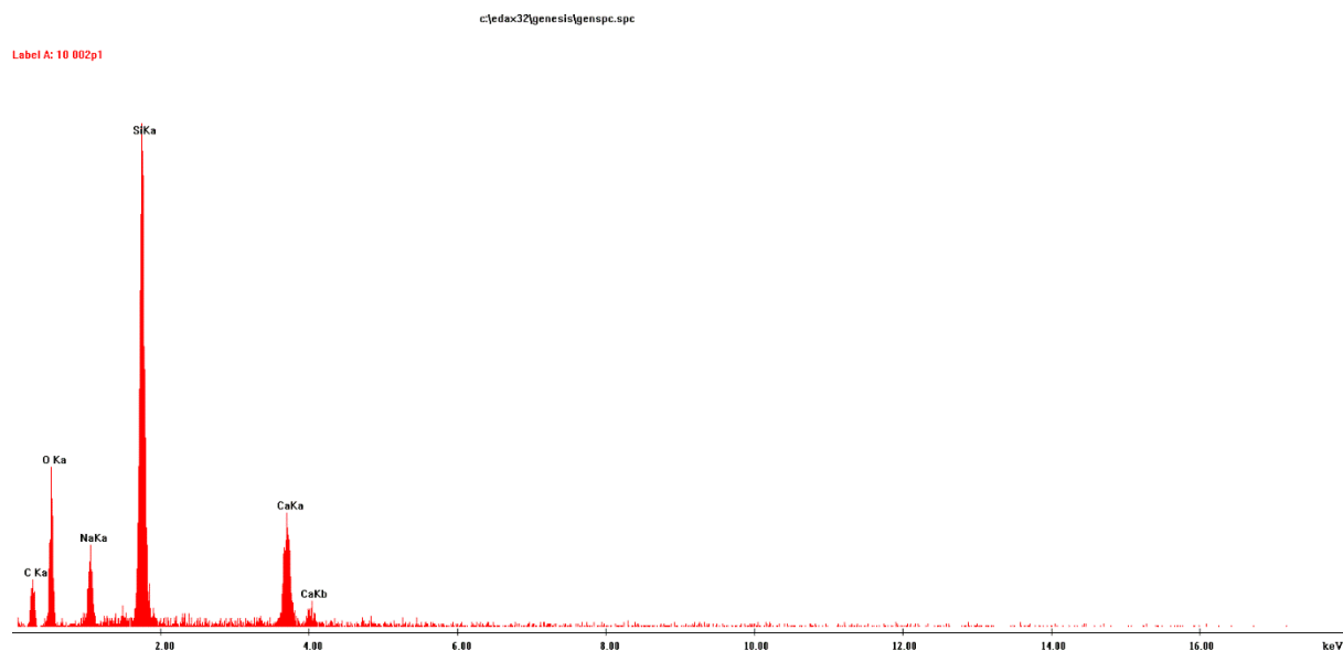
Rys. 151. Widma fluorescencji rentgenowskiej próbki nr 10, punktu 1
