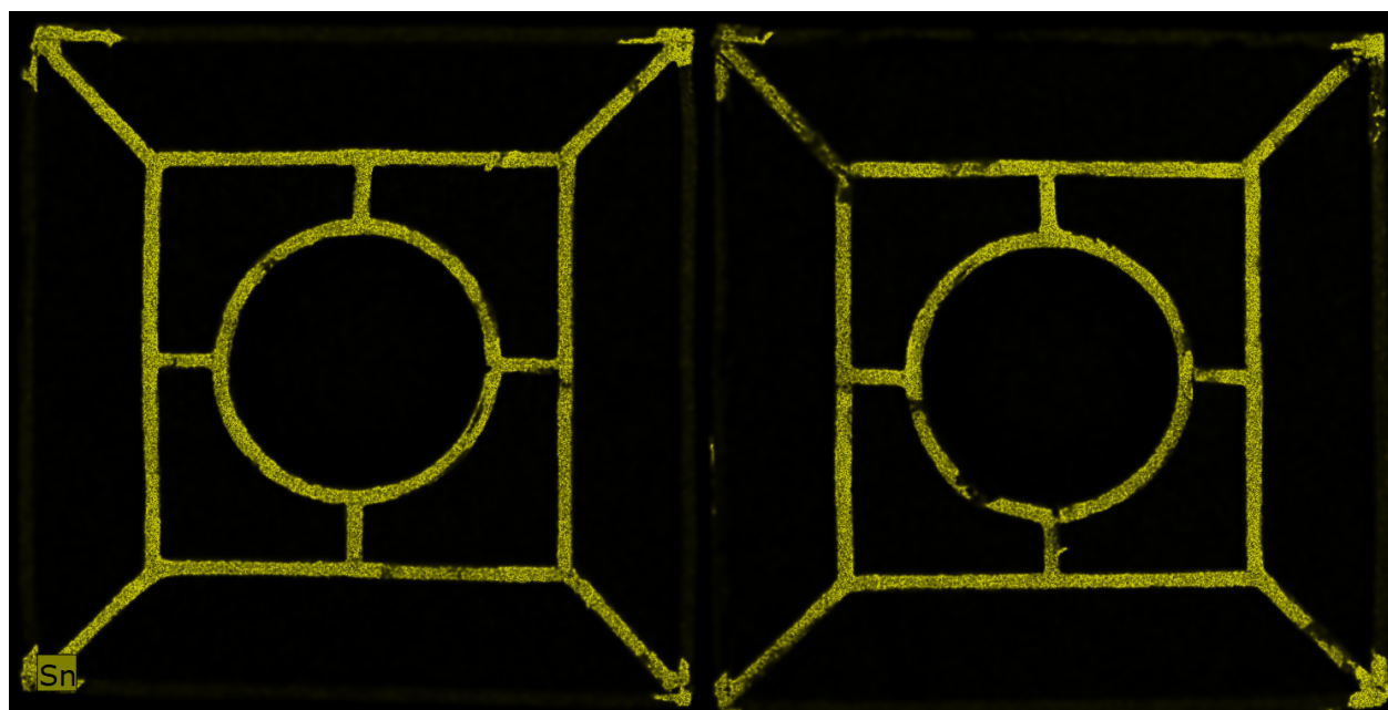
Sn-KA. Mapa rozkładu cyny – od strony wewnętrznej
