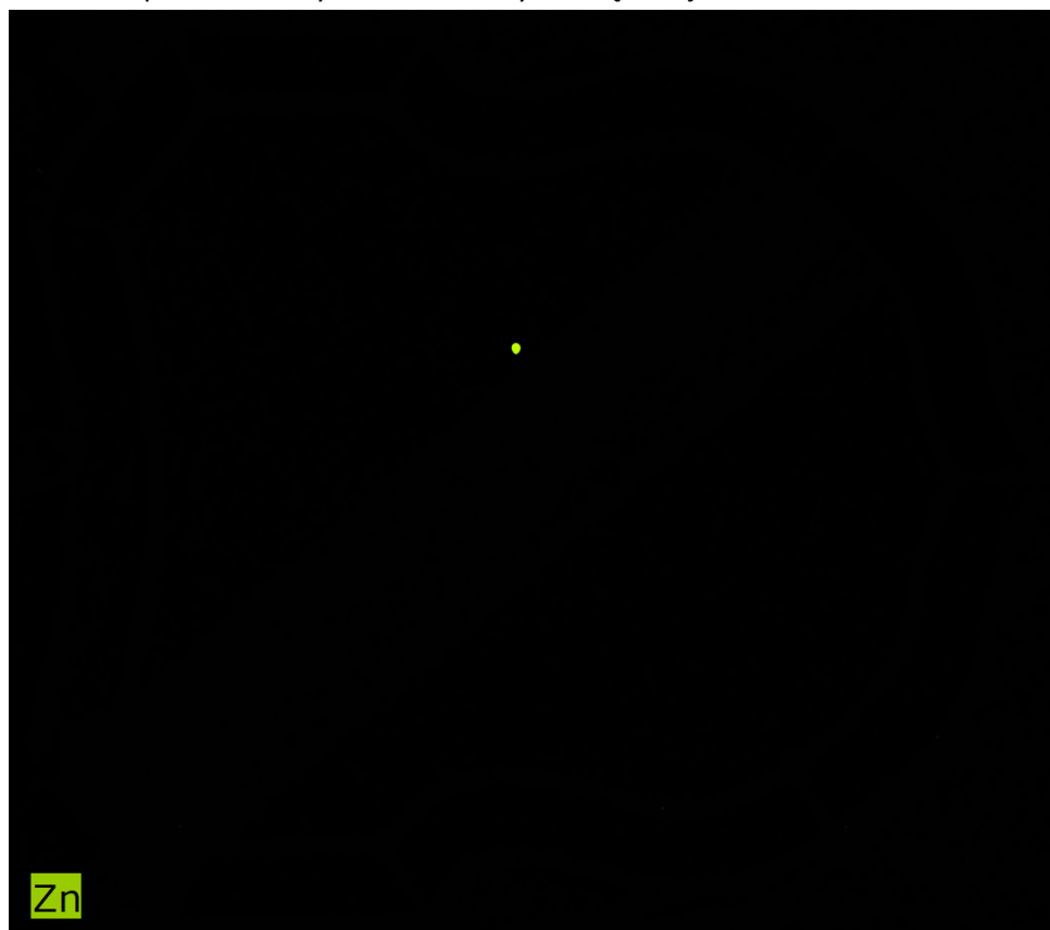
Zn-KA. Mapa rozkładu cynku – od strony zewnętrznej
