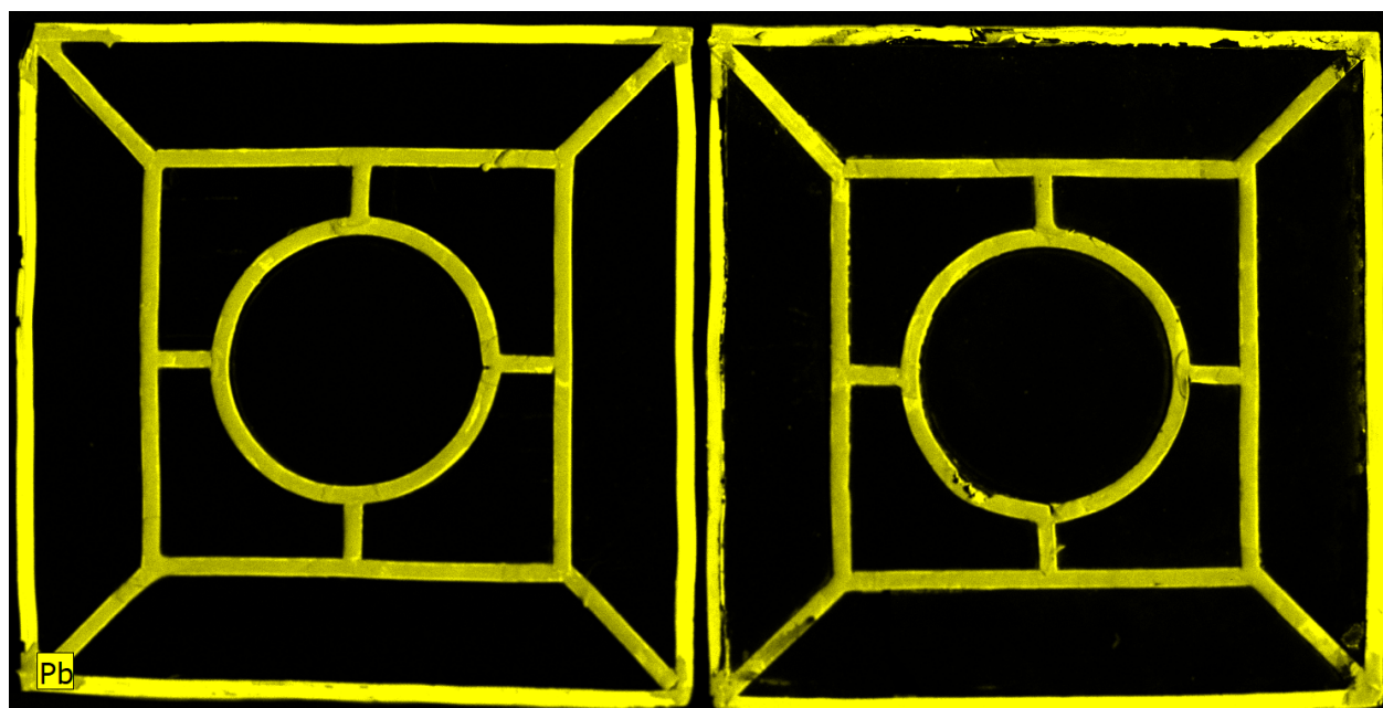
Pb-LB. Mapa rozkładu ołowiu – od strony wewnętrznej
