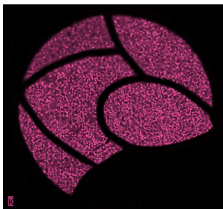
K-KA. Mapa rozkładu potasu – od strony wewnętrznej
