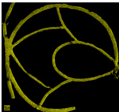
Sn-KA. Mapa rozkładu cyny – od strony wewnętrznej
