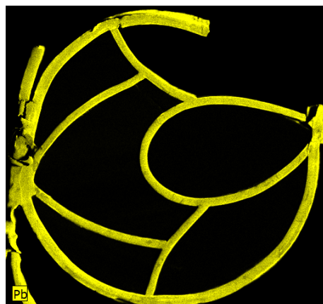
Pb-LA. Mapa rozkładu ołowiu – od strony zewnętrznej
