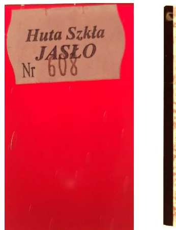
Il. 8. Przykład czerwonego szkła warstwowego, zdjęcie powierzchni i przełomu (Fot. Adam Kaźmierczak).
