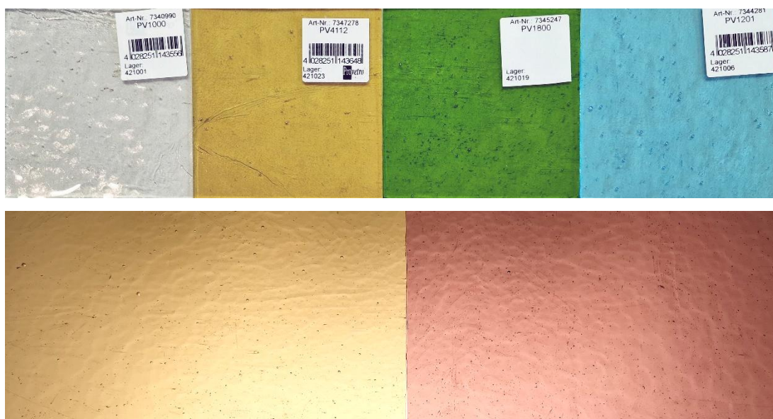
Il. 10. Przykładowe szkła katedralne z oferty firmy Provetro. Od lewej: bezbarwne PV1000, żółte PV4112, zielone PV1800, błękitne PV1201, u dołu dwa inne przykłady (Fot. Adam Kaźmierczak).
