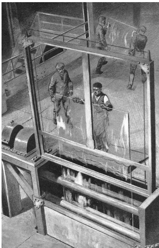
Il. 25. Belgijska technologia Émile’a Fourcaulta – wyciąganie cienkiej wstęgi szkła bezpośrednio z wanny szklarskiej. Za: https://www.period-homes.com/hollander-historic-glass , Dostęp 23.04.2026.
