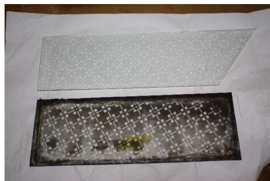
Il. 285. Szkła muślinowe z kamienicy przy ul. Jagiellończyka 4 przed (u dołu) i po (u góry) oczyszczeniu (Fot. Adam Kaźmierczak).
