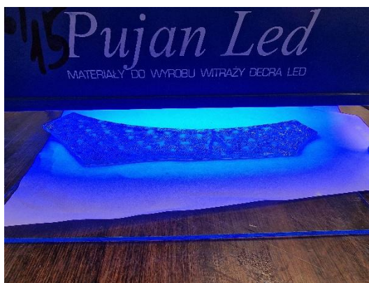
Il. 293. Klejenie szkła ornamentowego z kamienicy przy ul. Poniatowskiego 1 klejem utwardzanym światłem UV. (Fot. Adam Kaźmierczak).
