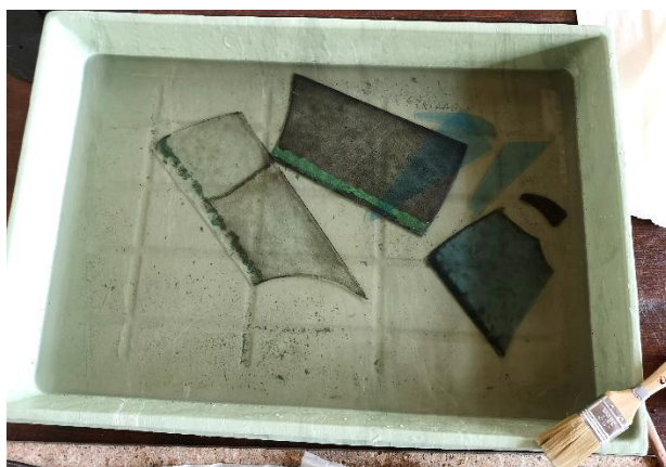
Il. 275. Fragmenty szkieł z kwatery witrażowej III2a z kamienicy przy ul. Poniatowskiego 1 w trakcie kąpieli w 6% roztworze fosforanu trójsodowego dwunastowodnego (Fot. Adam Kaźmierczak).
