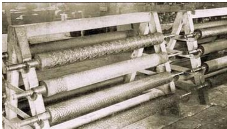
Il. 15. Walce do tłoczenia wzoru w szkło. Za: https://www.classesdupatrimoine.brussels/wp-content/uploads/2020/04/Technique-synth%C3%A8se.pdf , Dostęp 17.04.2026.
