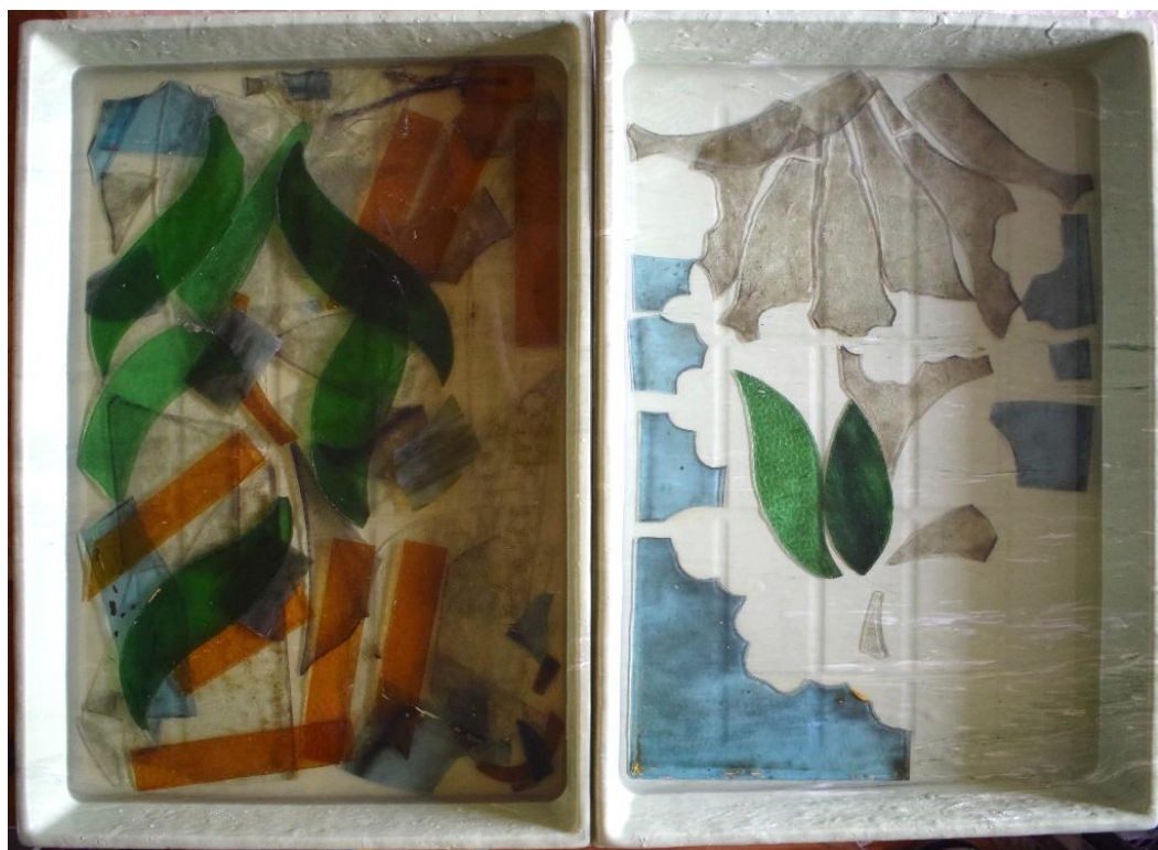
Il. 279. Szkła z kamienicy przy ul. Poniatowskiego 1 w trakcie kąpieli w 6% roztworze fosforanu trójsodowego dwunastowodnego (Fot. Adam Kaźmierczak).
