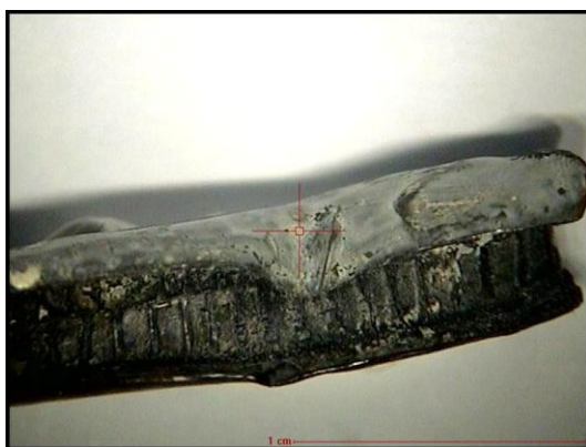
Il. 157. Listwa ołowiana z ul. Poniatowskiego 1 w Toruniu (Aneks II). Widok przykładowego obszaru pomiarowego strony zewnętrznej ER_To_12_02, 3x (po lewej) ze składem chemicznym (wt%): Ti 4,55, Fe <0,025, Co 0,08, Ni <0,015, Cu 0,12, Zn 15,83, Ag 0,01, Sn 47,33, Sb 0,14, Pb 31,81 oraz obszaru pomiarowego ER_To_12_03, 3x (po prawej) ze składem chemicznym (wt%): Ti 5,33, Fe 0,03, Co 0,08, Ni <0,015, Cu 0,19, Zn 17,14, Ag <0,02, Sn 45,71, Sb 0,13, Pb 31,25, Bi 0,13.
