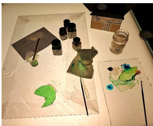
Il. 292. Etapy klejenia i uzupełniania ubytku zielonego szkła katedralnego żywicą epoksydową Araldite 2020 barwioną barwnikami Orasol (Fot. Adam Kaźmierczak).
