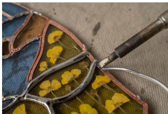
Il. 36. Lutowanie taśmy miedzianej w technice Tiffany. Za: https://www.domestika.org/pl/courses/2773-witraze-z-elementami-roslinnymi-metoda-tiffany-ego/final_project_lessons , Dostęp 23.04.2026.
