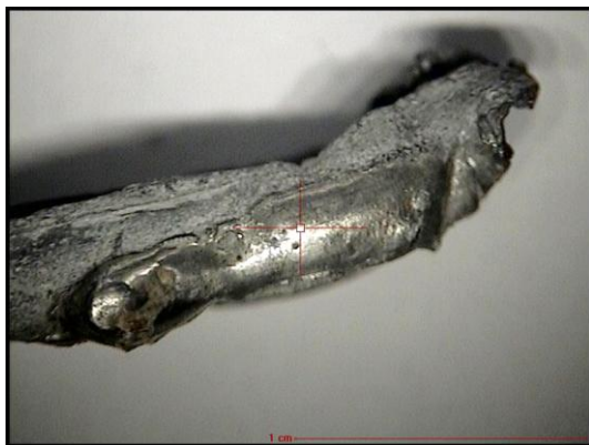
Il. 161. Listwa ołowiana z ul. Jagiellończyka 6 w Toruniu (Aneks II). Widok przykładowego obszaru pomiarowego strony zewnętrznej ER_To_13_02_3x ze składem chemicznym (wt%): Ti <0,03, Fe 0,03, Co 0,09, Ni <0,015, Cu 0,44, Zn 0,05, Ag <0,02, Sn 57,98, Sb 0,34, Pb 40,94, Bi 0,14.
