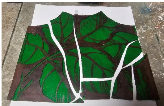
Il. 294. Szkło z witrażu budynku przy Placu Rapackiego 1 przed i po sklejeniu (Fot. Adam Kaźmierczak).
