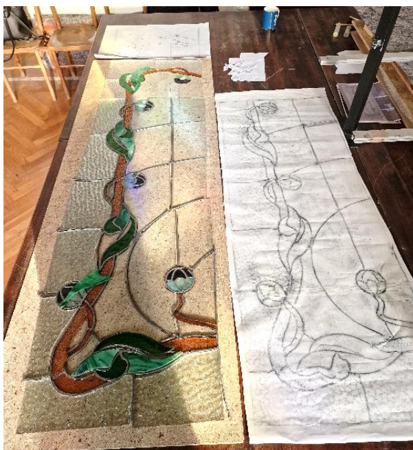
Il. 316. Wycinanie szkielek do aranżacji górnej części kwatery witrażowej IV2a z kamienicy przy ul. Poniatowskiego 1 (Fot. Adam Kaźmierczak).
