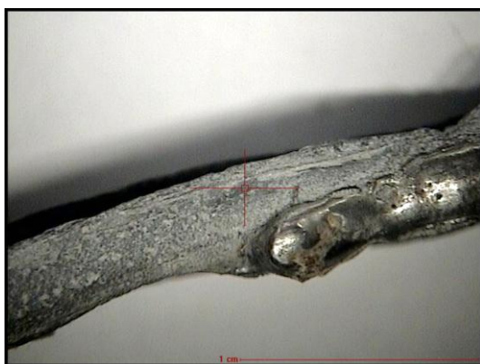
Il. 162. Listwa ołowiana z ul. Jagiellończyka 6 w Toruniu (Aneks II). Widok przykładowego obszaru pomiarowego rdzenia od strony zewnętrznej ER_To_13_06_3x ze składem chemicznym (wt%): Ti <0,03, Fe 0,05, Co 0,12, Ni 0,04, Cu 0,12, Zn 0,10, Ag <0,02, Sn 0,73, Sb 0,02, Pb 98,57, Bi 0,25.
