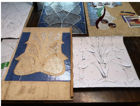
Il. 309. Wycinanie szkieł do rekonstruowanej kwatery witrażowej IIa z kamienicy przy ul. Poniatowskiego 1 (Fot. Adam Kaźmierczak).
