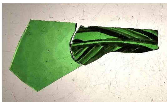
Il. 305. Uzupełnianie ubytków szkła i wycinanie nowych fragmentów do częściowych rekonstrukcji w kwadrach witraży secesyjnych z budynku przy Placu Rapackiego 1 (Fot. Adam Kaźmierczak).
