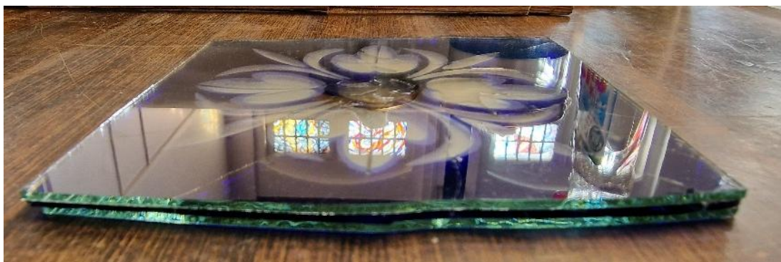
Il. 387. Zdublowana na sucho rozetka IIIA/7c dwoma szklami float 2 mm z kamienicy przy ul. Jagiellończyka 4 (Fot. Adam Kaźmierczak).
