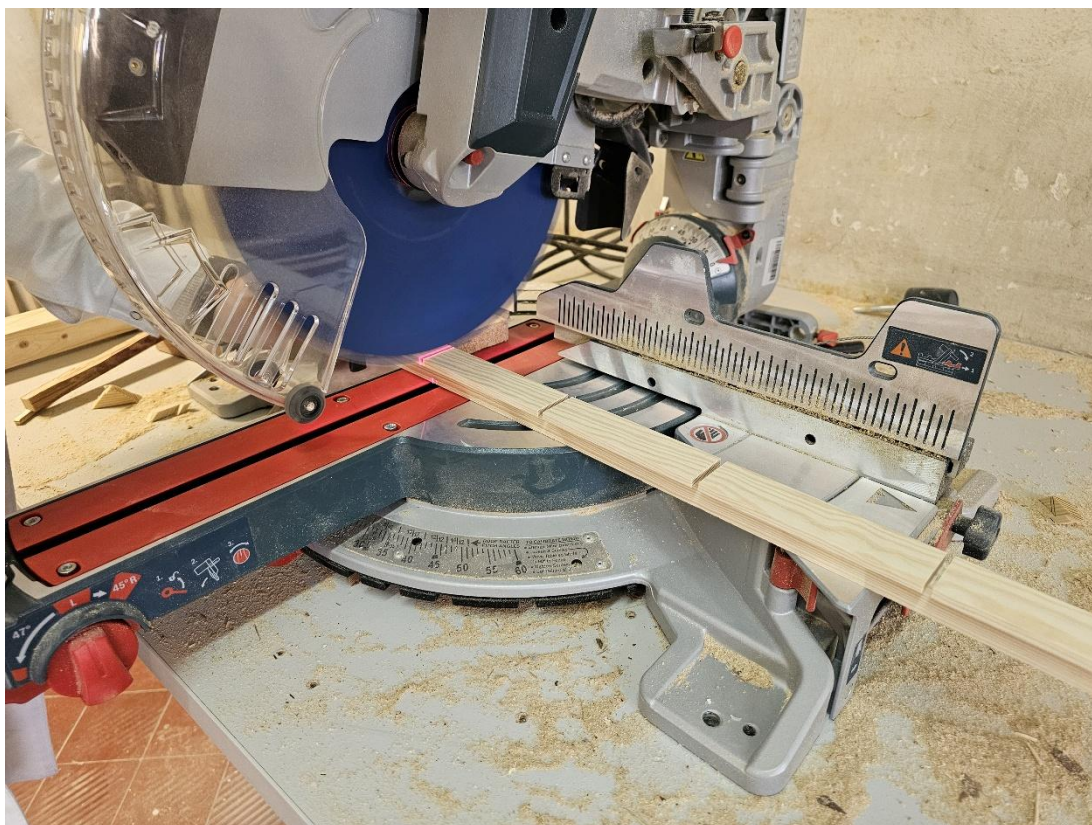
Il. 378. Nacinanie otworów wentylacyjnych w nowych ramach montażowych dla witraży z budynku przy Placu Rapackiego 1 (Fot. Adam Kaźmierczak).
