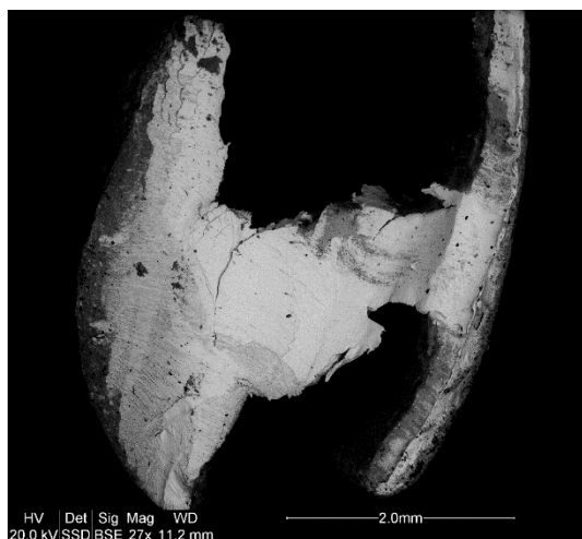
Il. 166. Listwa ołowiana z ul. Mostowa 9 w Toruniu (Aneks II). Przykładowy obraz BSE topografii powierzchni próbki 14, obszar 2 ze składem chemicznym w mikroobszarze 14-2-1 (wt%): Pb 92,52, Sn 2,84, C 4,64.
