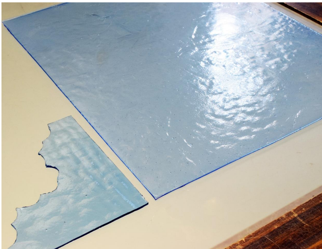
Il. 327. Zestawienie oryginalnego szkła katedralnego (po lewej) z odtworzoną fakturą ze szkła antycznego (po prawej) (Fot. Adam Kaźmierczak).
