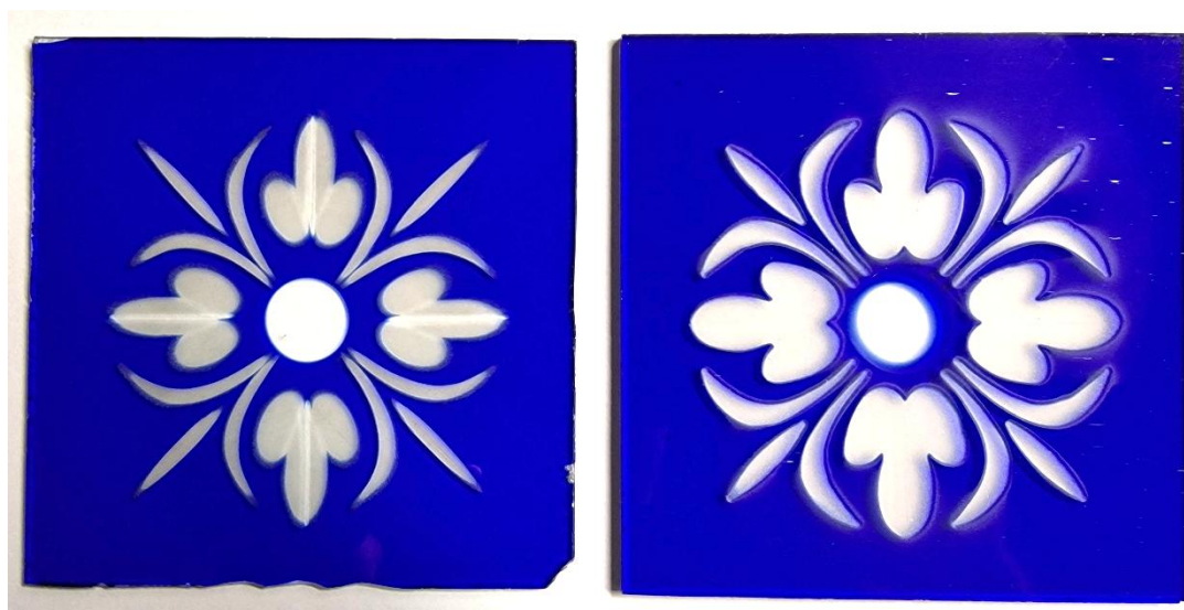
Il. 302. Zestawienie oryginalnej (po lewej) i współczesnej rozetki (po prawej) uważanej przez producenta za kopię XIX-wiecznej rozetki szlifowanej i polerowanej (Fot. Adam Kaźmierczak).
