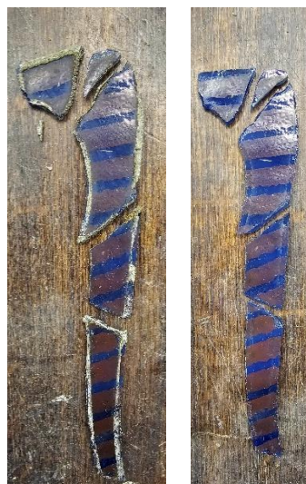
Il. 271. Przykłady szkieł witraży z budynku przy Placu Rapackiego 1 przed i po oczyszczeniu (Fot. Adam Kaźmierczak).
