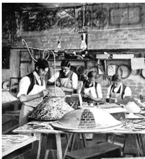
Il. 34. Pracownicy Tiffany Studios w trakcie wykonywania kloszy lamp w technice taśmy miedzianej, kon. XIX w. Za: https://www.copper.org/consumers/arts/2008/july/Shedding_Light%20_Legacy_Tiffany.html .
