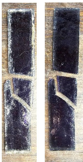
Il. 271. Przykłady szkieł witraży z budynku przy Placu Rapackiego 1 przed i po oczyszczeniu (Fot. Adam Kaźmierczak).
