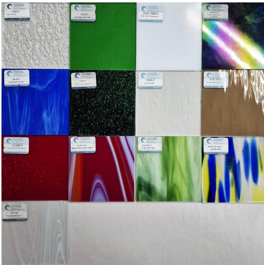
Il. 325. Przykładowe szkła ze wzornika firmy Oceanside Glas & Tile – Oceanside Compatible™ System 96. Od lewej górnej próbki: 100G-F Clear Granite, 121S-F Light Green Solid Transparent, 200S-2MM-F White Solid Opalescent, 1009S-F-IR Black Iridescent Solid Opalescent, 339-2S-F Light Blue/White Wispy, 128AV-F Dark Green Aventurine, 100A-F Clear Artique®, 518-1W-F Bronze Waterglass®, 151RR-F Cherry Red Rough Rolled, OA-355-1S-F Strawberries & Cream OpalArt, 6022-82CC-F Congo Pearl Opal, Spirit-4361-76S-F Atlantis Spirit, BR-308 White/Clear Baroque™ (Fot. Adam Kaźmierczak).
