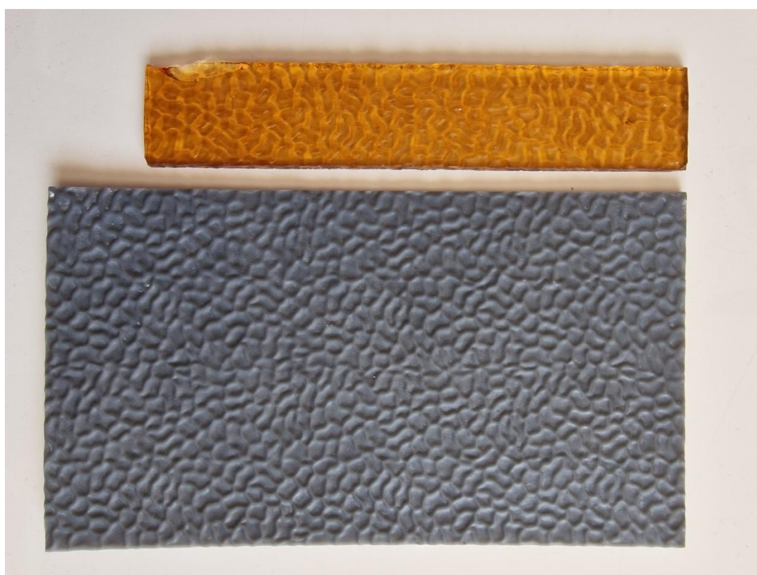
Il. 333. Etapy tworzenia modelu szkła 3D, od lewej góry: wydruk żywiczny modelu; utwardzanie modelu w świetle UV; zestawienie fragmentu oryginalnego szkła ornamentowego z gotowym modelem żywicznym (Fot. Adam Kaźmierczak).
