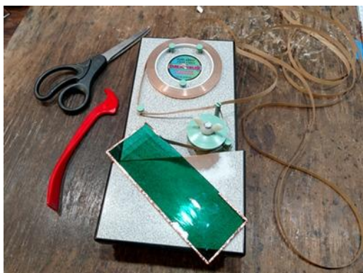
Il. 35. Technika Tiffany. Oklejanie kawałka szkła taśmą miedzianą. Za: https://www.stainedglassyourway.com/blog/stained-glassconstruction-methods , Dostęp 23.04.2026.
