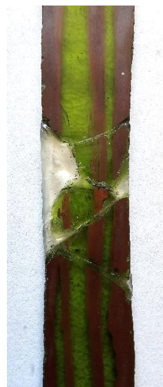
Il. 295. Szkło z budynku przy Placu Rapackiego 1 przed sklejeniem, po sklejeniu i po uzupełnieniu ubytku szkła żywicą epoksydową Araldite 2020 (Fot. Adam Kaźmierczak).
