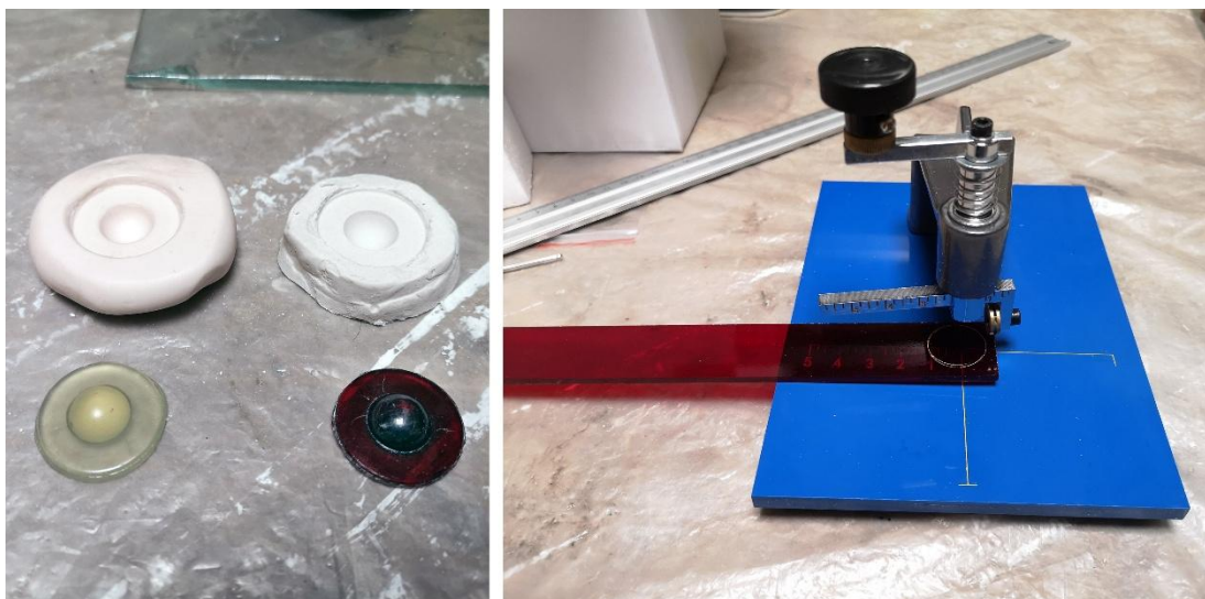
Il. 335. Etapy odtwarzania czerwonych kaboszonów od lewej: silikonowy i gipsowy (ceramiczny) odlew kaboszonu; wycinanie szklanych krążków (Fot. Adam Kaźmierczak).
