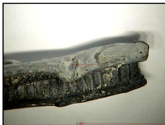
Il. 157. Listwa ołowiana z ul. Poniatowskiego 1 w Toruniu (Aneks II). Widok przykładowego obszaru pomiarowego strony zewnętrznej ER_To_12_02, 3x (po lewej) ze składem chemicznym (wt%): Ti 4,55, Fe <0,025, Co 0,08, Ni <0,015, Cu 0,12, Zn 15,83, Ag 0,01, Sn 47,33, Sb 0,14, Pb 31,81 oraz obszaru pomiarowego ER_To_12_03, 3x (po prawej) ze składem chemicznym (wt%): Ti 5,33, Fe 0,03, Co 0,08, Ni <0,015, Cu 0,19, Zn 17,14, Ag <0,02, Sn 45,71, Sb 0,13, Pb 31,25, Bi 0,13.
