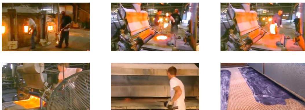
Il. 18. Etapy tworzenia szkła mąconego: nabieranie porcji szkła nabierakiem, wlewanie kolejnych porcji szkła na stalowy blat, mącenie szkła widłami, walcowanie szkła, odprężanie szkła, gotowa tafla szkła po odprężaniu. Kadry za: https://www.youtube.com/watch?v=tDyeiePort0 , Dostęp 23.04.2026.
