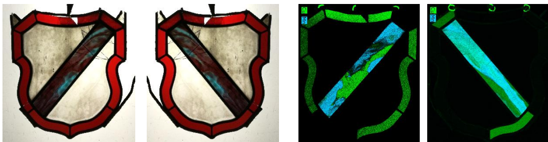
Il. 152. Analiza Makro XRF szkła kartusza herbowego z kwatery okna I 2b klatki schodowej kamienicy przy ul. Poniatowskiego 1 w Toruniu. Rozkład pierwiastków – mapowanie: miedzi i manganu (po lewej strona wewnętrzna, po prawej zewnętrzna).
