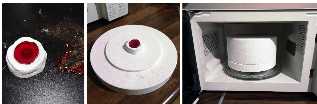
Il. 336. Etapy odtwarzania czerwonych kaboszonów od lewej: forma gipsowa wypełniona szkłem; forma ze szkłem ustawiona na podstawce HotPotu; zamknięty HotPot w kuchence mikrofalowej przed wypałem szkła (Fot. Adam Kaźmierczak).
