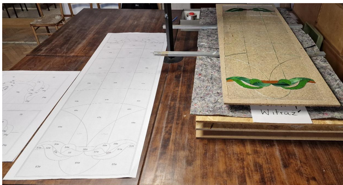
Il. 318. Wycinanie szkielek do aranżacji kwatery witrażowej IV2b z kamienicy przy ul. Poniatowskiego 1 (Fot. Adam Kaźmierczak).
