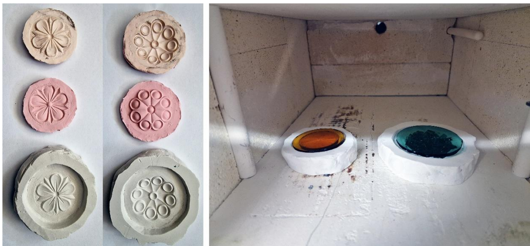
Il.339. Etapy odtwarzania szmaragdowej i żółtej rozetki, od lewej: odlewy rozetek – patrząc od góry: negatywy z gęstego silikonu dentystycznego, pozytywy z silikonu formierskiego oraz odlewy negatywowe z gipsu ceramicznego z mączką kwarcową; formy gipsowe ze szkłem umieszczone w piecu przed wypaleniem (Fot. Adam Kaźmierczak).
