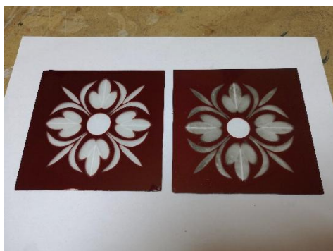
Il. 284. Szlifowane rozetki z kamienicy przy ul. Jagiellończyka 4 przed (po prawej) i po (po lewej) oczyszczaniu (Fot. Adam Kaźmierczak).
