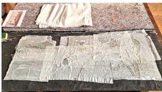
Il. 276. Okłady z ligniny nasączonej 6% fosforanem trójsodowym dwunastowodnym. Po prawej widoczne przebarwienia ligniny świadczące o rozpuszczeniu zabrudzeń. Witraże z kamienicy przy ul. Poniatowskiego 1 (Fot. Adam Kaźmierczak).
