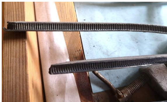
Il. 32. Współczesne walcowane (ciągnione) listwy ołowiane (Fot. Adam Kaźmierczak).
