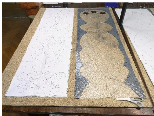
Il. 312. Wycinanie szkieł do rekonstruowanej kwatery witrażowej II2b z kamienicy przy ul. Poniatowskiego 1 (Fot. Adam Kaźmierczak).
