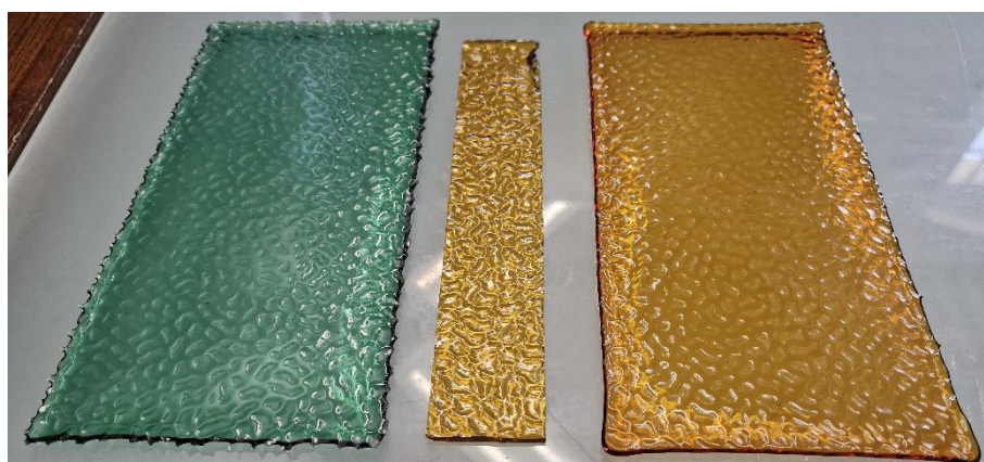
Il. 334. Etapy odtworzenia szkła z żywicznego modelu 3D, od góry: żywiczny model z negatywowym odlewem z gipsu ceramicznego z mączką kwarcową; ułożone tafle szkła na formach negatywowych w piecu; zestawienie oryginalnego szkła ornamentowe (pośrodku) z odtworzonymi taflami (po bokach) (Fot. Adam Kaźmierczak).
