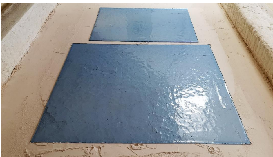
Il. 326. Etapy termoformowania szkła antycznego na fakturę szkła katedralnego, od lewej: separator z odbitą fakturą szkła katedralnego; ułożone tafle przed wypałem; tafle po wypaleniu (Fot. Adam Kaźmierczak).
