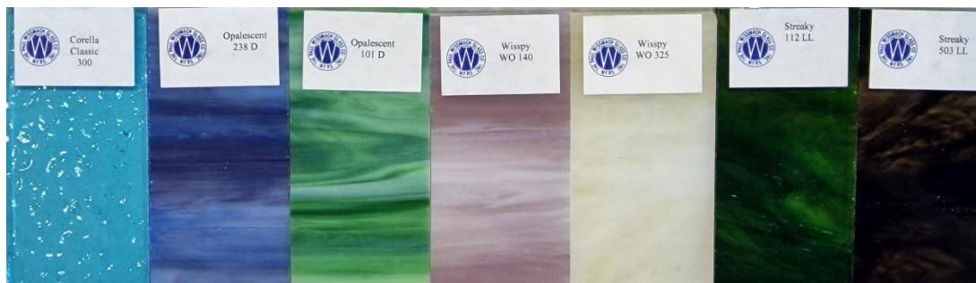
Il. 19. Współczesne przykładowe szkła mącone (opalowe) ze wzornika firmy Paul Wissmach Glass. Od lewej próbki: Corella Classic 300, Opalescent 238 D, Opalescent 101 D, Wisspy WO 140, Wisspy WO 325, Streaky 112 LL, Streaky 503 LL (Fot. Adam Kaźmierczak).
