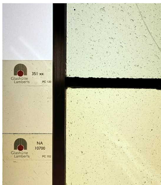
Il. 5. Przykład dmuchanego szkła antycznego z charakterystycznymi pęcherzykami powietrza (Fot. Adam Kaźmierczak).
