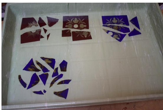
Il. 280. Rozetki szlifowane z kamienicy przy ul. Jagiellończyka 4 w trakcie kąpeli w 6% roztworze fosforanu trójsodowego dwunastowodnego (Fot. Adam Kaźmierczak).
