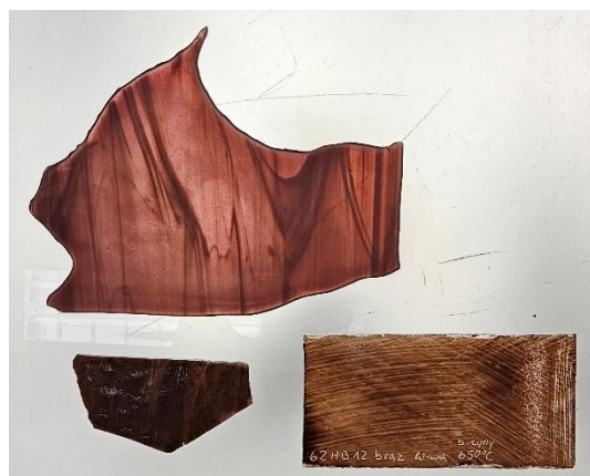
Il. 306. Próby kolorystyczne brązowej farby szklanej (po lewej) i efekt końcowy po wypaleniu farby na szkło opalowym (po prawej) do uzupełnień szkła podstawy kompozycji witraży z budynku przy Placu Rapackiego 1 (Fot. Adam Kaźmierczak).
