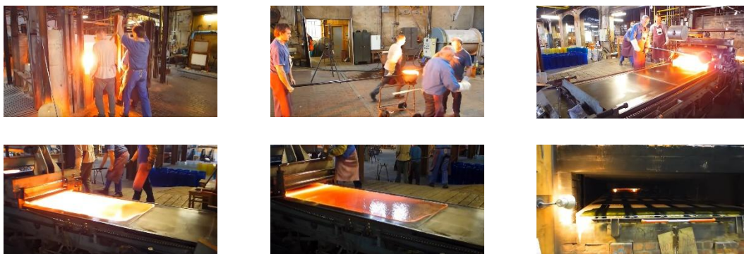
Il. 9. Etapy tworzenia szkła katedralnego: nabieranie porcji szkła czerpakiem, wylanie masy szklanej na stalowy stół, przewalcowanie szkła i odprężanie tafli.
