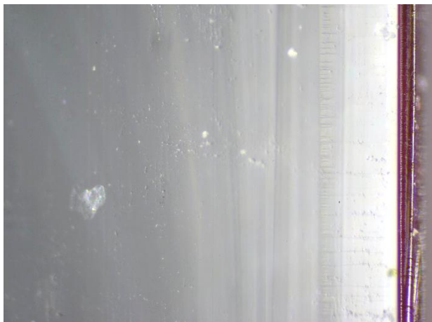
Il. 7. Mikroskopowe zdjęcie przełomu rubinowego szkła powłokowego (Fot. Adam Kaźmierczak).
