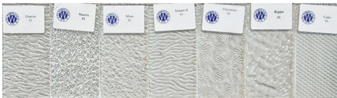
Il. 17. Współczesne przykładowe szkła ornamentowe ze wzornika firmy Paul Wissmach Glass. Od lewej próbki: Granite 01, Matrix 01, Moss 01, Stream-X 01, Florentine 01, Ripple 01, Cube 01 (Fot. Adam Kaźmierczak).
