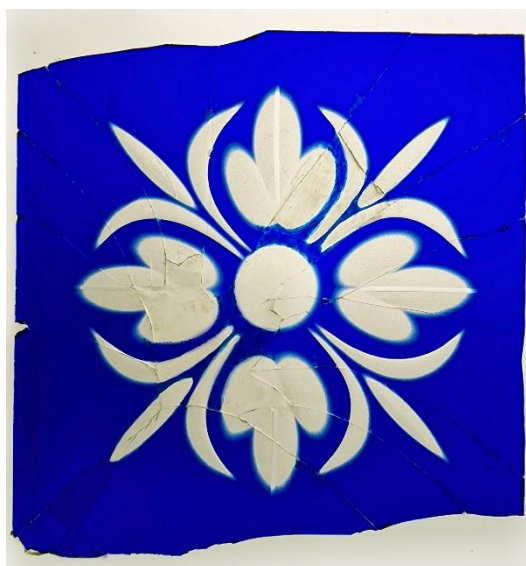
Il. 371. Rozetka IIIA/7c przed i po scaleniu kolorystycznym na zimno z kamienicy przy ul. Jagiellończyka 4 (Fot. Adam Kaźmierczak).
