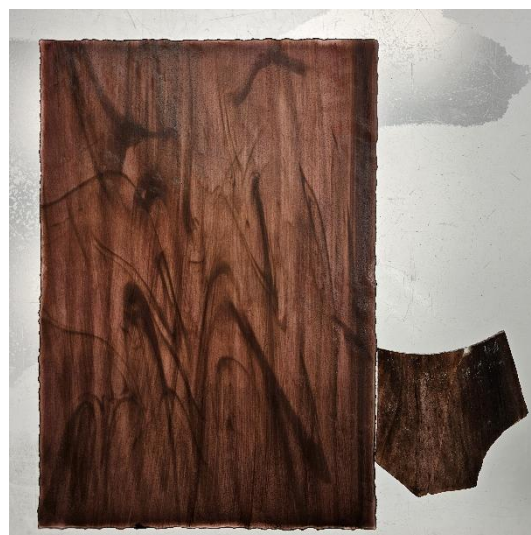
Il. 306. Próby kolorystyczne brązowej farby szklanej (po lewej) i efekt końcowy po wypaleniu farby na szkło opalowym (po prawej) do uzupełnień szkła podstawy kompozycji witraży z budynku przy Placu Rapackiego 1 (Fot. Adam Kaźmierczak).
