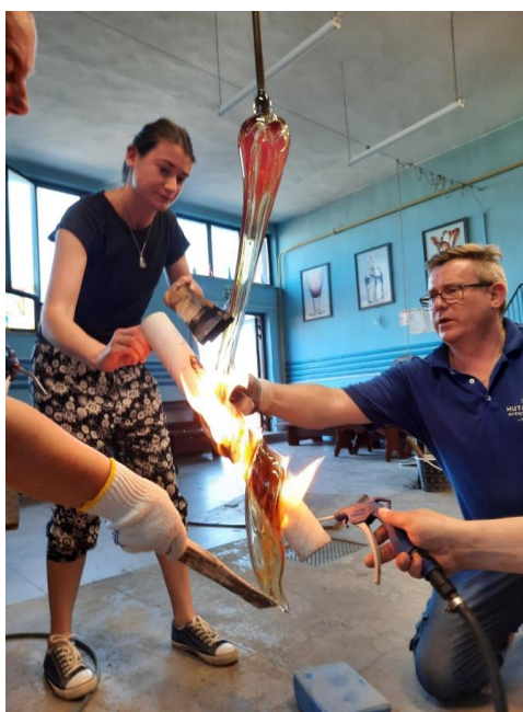
Ilustracja 26. Wykonywanie szkła wykorzystanego do próby neonowej. Realizacja w Hucie Szkła Artystycznego w Olsztynku, 2020 r.
