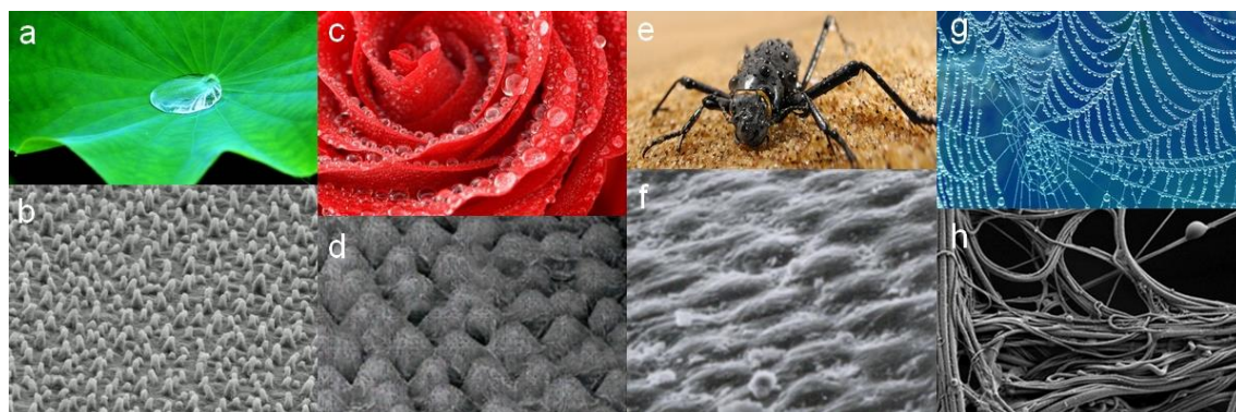
Ryc. 5 Przykładowe powierzchnie biomimetyczne wraz z obrazami SEM. Liść Lotosu (a, b), na podstawie publikacji [45], płatek róży (c, d), na podstawie publikacji [46], pancerz chrząszcza z pustyni Namibijskiej (e, f), na podstawie publikacji [47], sieć pajęcza (g, h), na podstawie publikacji [48].
