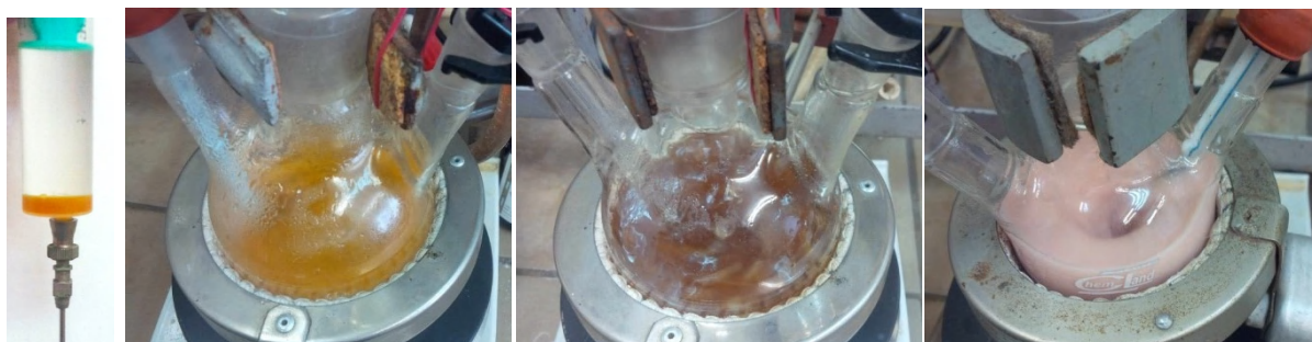
Rys. 48. Wygląd mieszaniny reakcyjnej po dodaniu katalizatora. Od lewej: roztwór wodny katalizatora w strzykawce przed reakcją; po dodaniu roztworu \text{FeCl}_3 w \text{H}_2\text{O} ; po dodaniu roztworu \text{FeCl}_3 w DMSO; po dodaniu roztworu \text{FeCl}_3 w THF
