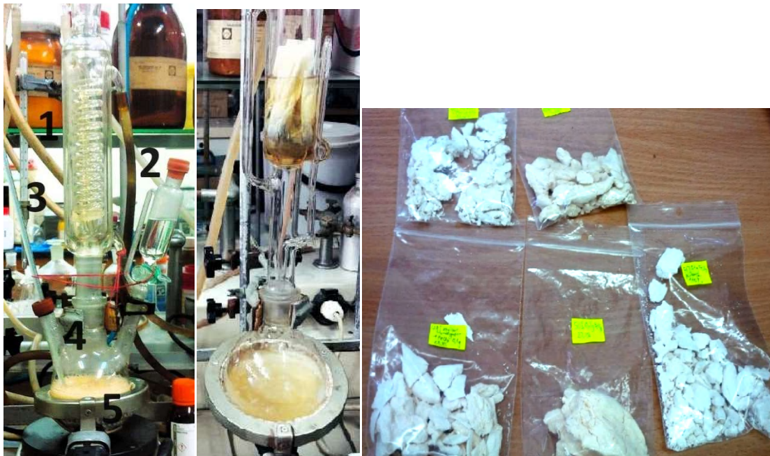
Rys. 47. Od lewej: zestaw laboratoryjny używany w większości reakcji na 5 g polipropylenu: 1 – chłodnica zwrotna, 2 – wkraplacz, 3 – termometr, 4 – kolba okrągłodenna, 5 – płaszcz grzewczy; aparat Soxhleta do ekstrakcji acetonowej; modyfikowany polipropylen po syntezie i oczyszczeniu
