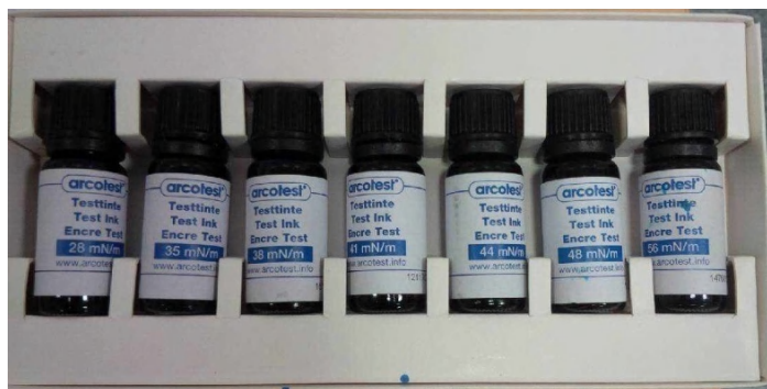
Rys. 74. Płyny służące do sprawdzania zwilżenia powierzchni
