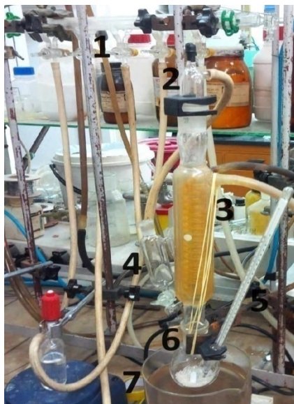
Rys. 44. Zestaw laboratoryjny używany w pierwszych syntezach. 1 - odpowietrzenie / doprowadzenie gazu N 2 ; 2 - nasadka doprowadzająca; 3 - chłodnica zwrotna; 4 - wkraplacz; 5 - termometr; 6 - kolba; 7 - łaźnia olejowa
