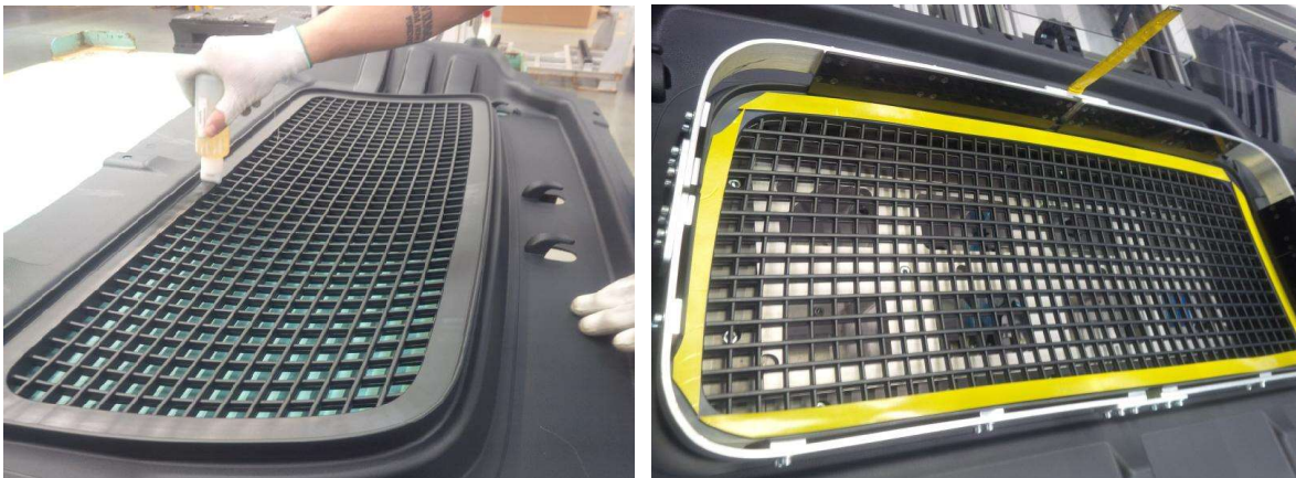
Rys. 104. Etapy nakładania primeru (lewa strona) i taśmy klejącej (prawa strona)
