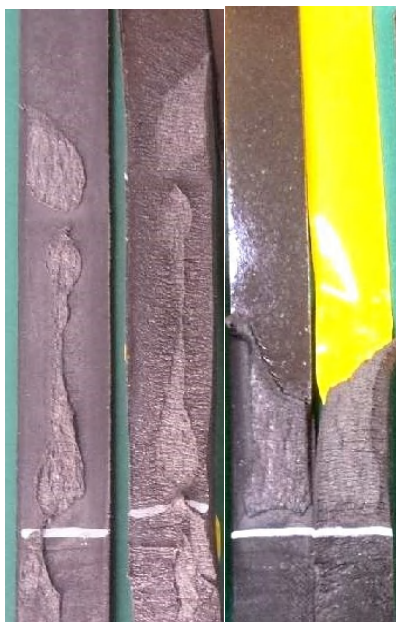
Rys. 99. Rodzaje zniszczenia kohezyjnego próbek podczas badań oddzierania metodą peel 180°. Po lewej: zniszczenie w formie wysp; po prawej całkowite zniszczenie kohezyjne
