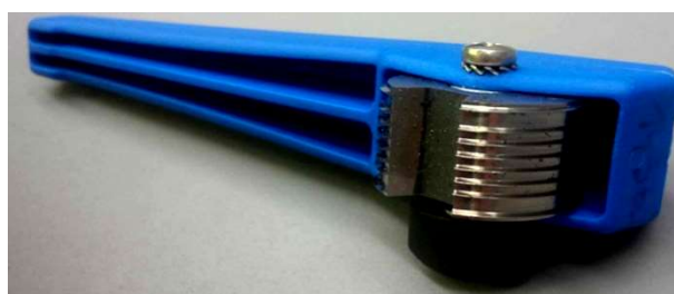
Rys. 36. Góra – kierunek oddzierania taśmy klejącej podczas testu kratki; środek - klasyfikacja jakości powłoki adhezyjnej po teście kratki według ISO 2409; dół – nóż Petersa, który służył do wykonania siatki nacięć
