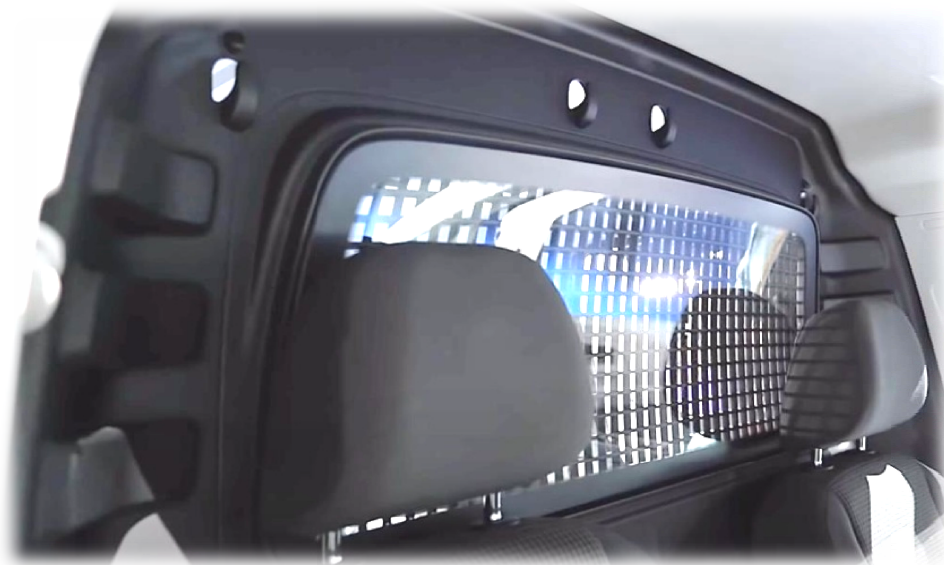
Rys. 29. Położenie szyby w ścianie grodziowej wewnątrz samochodu
