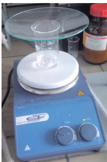
Rys. 76. Początkowy sposób przygotowywania primera w zlewce
