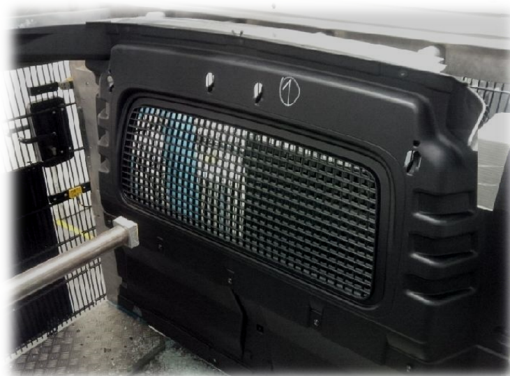
Rys. 30. Badania wytrzymałościowe całych ścian grodziowych według normy DIN 16742:2013-
