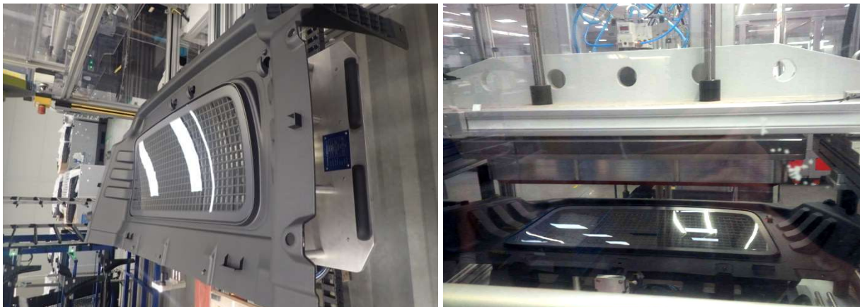
Rys. 105. Etapy nakładania szyby szklanej (lewa strona) i docisku prasy hydraulicznej (prawa strona)
