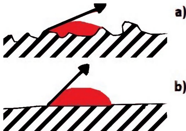
Rys. 7. Zwilżanie powierzchni: a) rzeczywistej, posiadającej wgłębienia, b) wyidealizowanej, gładkiej
