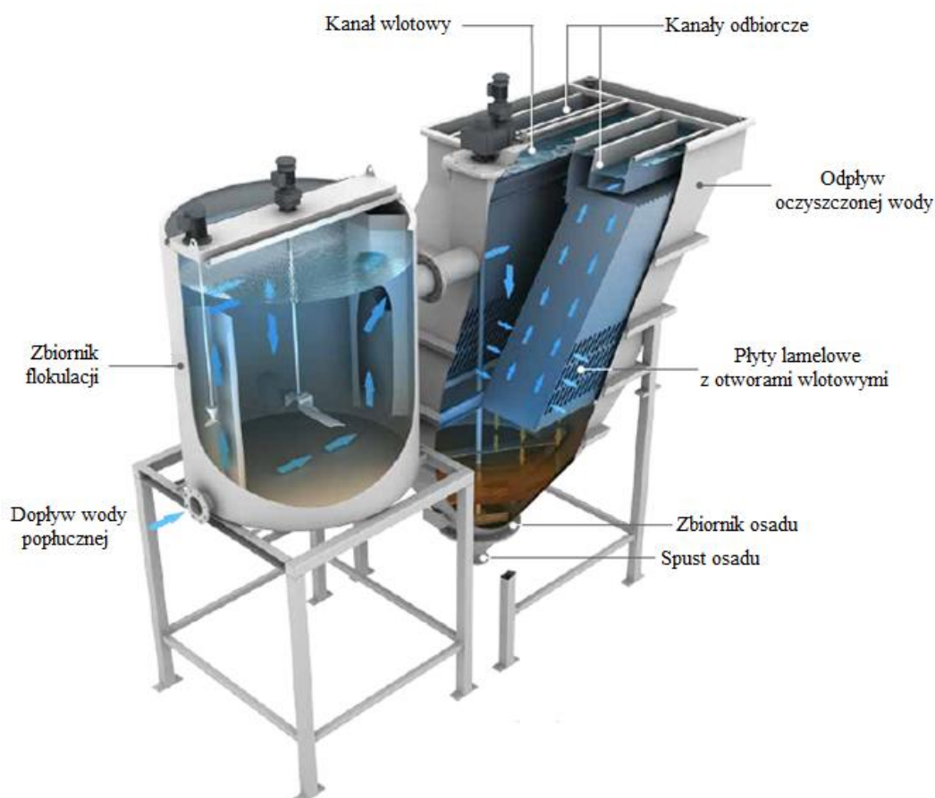
Rys. 2. Osadnik Lamella ze zbiornikiem flokulacji (na podstawie materiałów informacyjnych firmy AWP Nordic products) (źródło internetowe: https://awpnp.pl/lib/z206h7/S1301_Lamella_PL_Web-jc08xusc.pdf )
